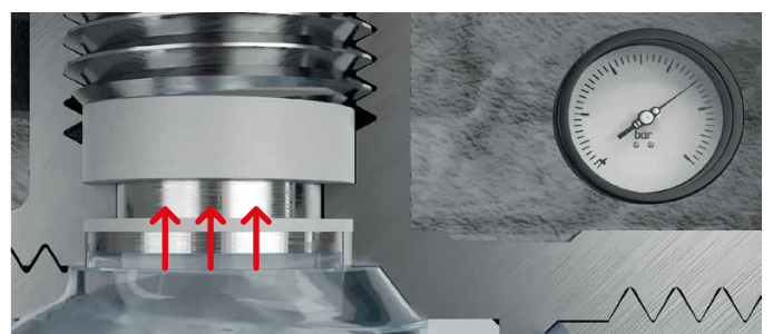
A nyomás hatására megnövekvő tömítőhatás
